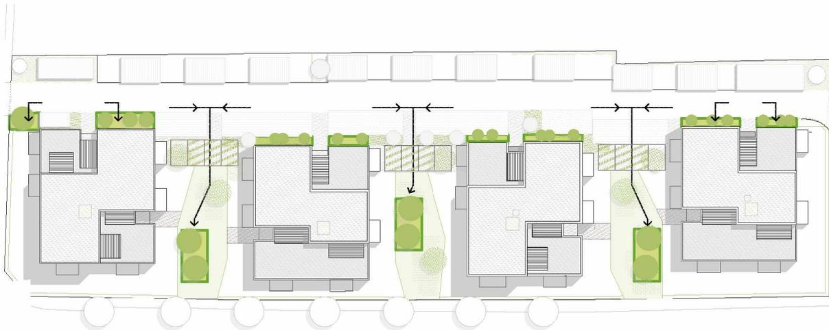
Dabei wird das Konzept eines innovativen und intelligenten Regenwassermanagements verfolgt, das neben der sehr raschen Aufnahme von Niederschlagswässern in den Sickerbereichen eine ordnungsgemäße Filterung und Reinigung der anfallenden Wässer sicherstellt.
